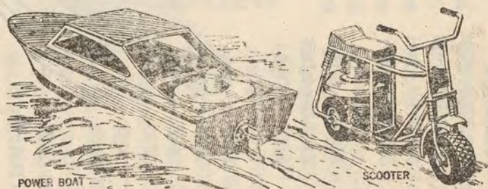
圖六：超級飛輪也可用來推動船艇、機器腳踏車、剪草機與家庭工具等。
