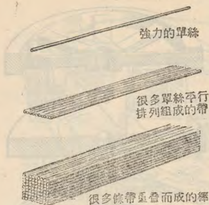
圖(乙)：令超級飛輪具有額外的輻射向強度之基本因素，是強力的線或絲，如上圖。中圖爲由很多線平行排列聯結而成的帶。下圖爲由很多條此種帶重疊而成的棒。
