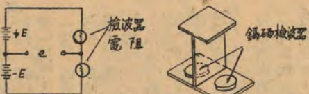
圖四 電流電路及錫碲檢波器之機械上的排列，由低基準之電阻而被選擇應用，它們構成一個五萬歐姆負荷，產生每度八伏特的輸出而無須放大。
