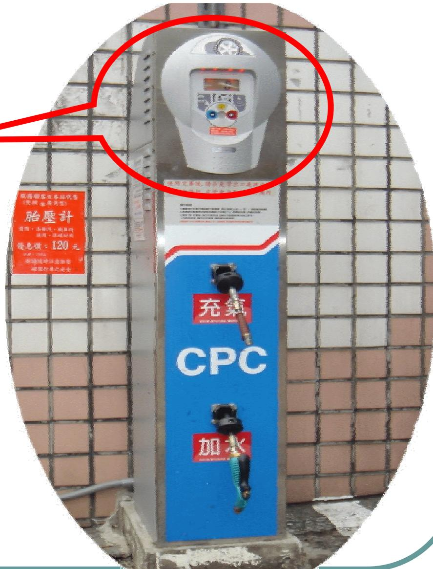
使用完畢後，請在皮管出口處將皮管輕輕往後拉，皮管會自動回收於機內
