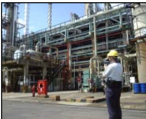
圖一 可攜式紅外線熱像儀於化工廠熱分布掃瞄之情形。
