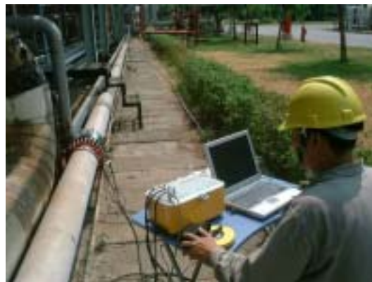
圖九 導波檢測法於長距離管線之量測
