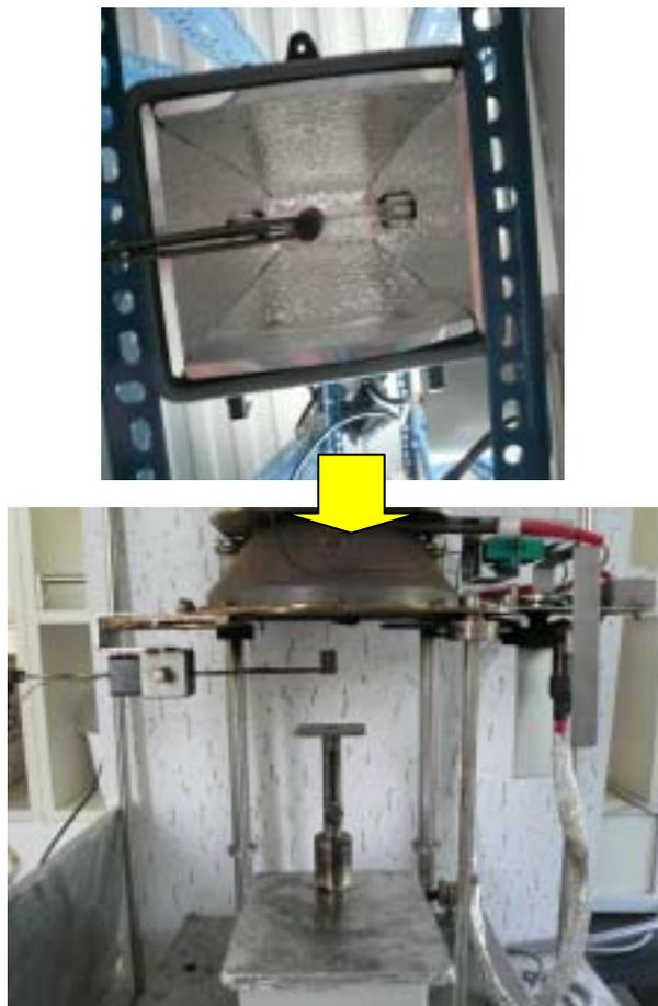
圖 3-4 熱通量計測量照明燈燈管中心點熱通量強度示意圖
