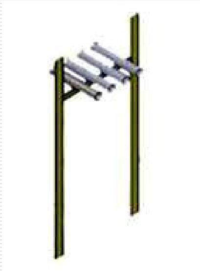
管架 Pipe Rack
