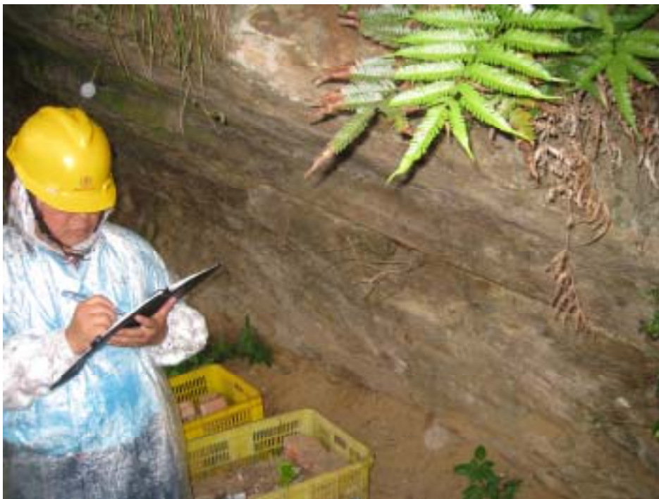
圖 10、磅磅仔（九份溪口）地層走向南 34^{\circ} 西地層傾角 北 22^{\circ} ，位置如圖 12 之 64。
