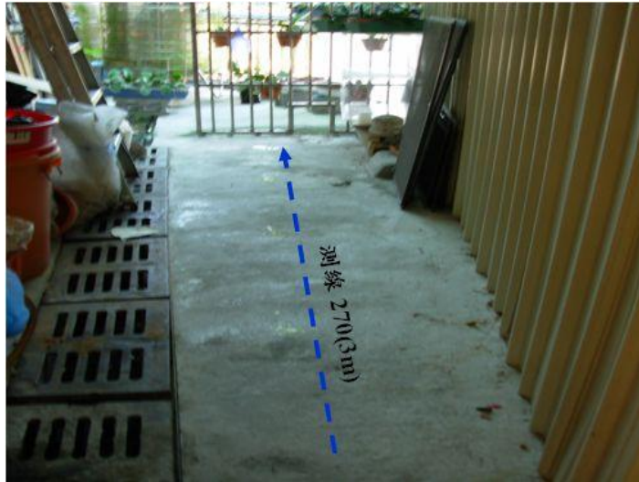
圖十一：透地雷達辦公室後面現場施測示意圖
