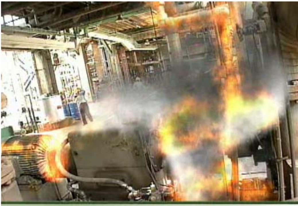
經拆 GA-104 泵浦檢查，發現該冷卻水積垢，依此研判軸承冷卻效果不佳，致使滑油溫度上升，造成軸承磨損，振動增加，導致機械軸封損壞，因為油料洩漏又轉軸聯接器扭斷產生火花引起火警改善
